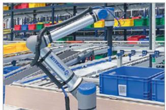
**Ruka.** Kompaktna robotska ruka visokih performansi s uređajem za hvatanje integriranim na kraju. Pruža maksimalnu radnu učinkovitost i dug domet do 1300 mm.
