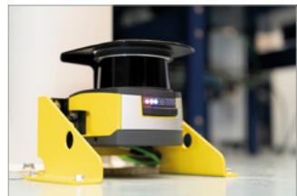
**Rotoscan.** Laserski skener koji aktivira smanjeni način rada kada detektira prisutnost operatera u radnom području robota. Ovaj način rada usporava brzinu robota kako bi dao prednost sigurnosti ljudi u njegovoj blizini.
