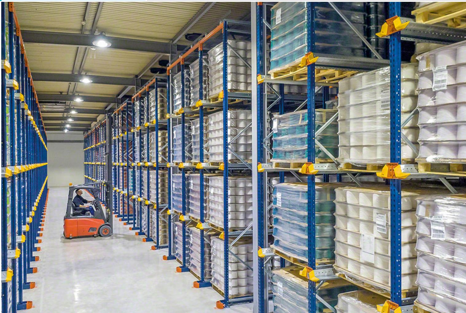
Ovaj koncept skladišta sastoji se od skupa stalažnih jedinica koje tvore stazu s potpornim vodilicama za palete. Viličar ulazi u stazu s tovarom uzdignutim iznad potporne vodilice na koju će ga postaviti.
