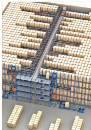
**Instalacija automatskih sustava Pallet Shuttle s kolicima za transport**
