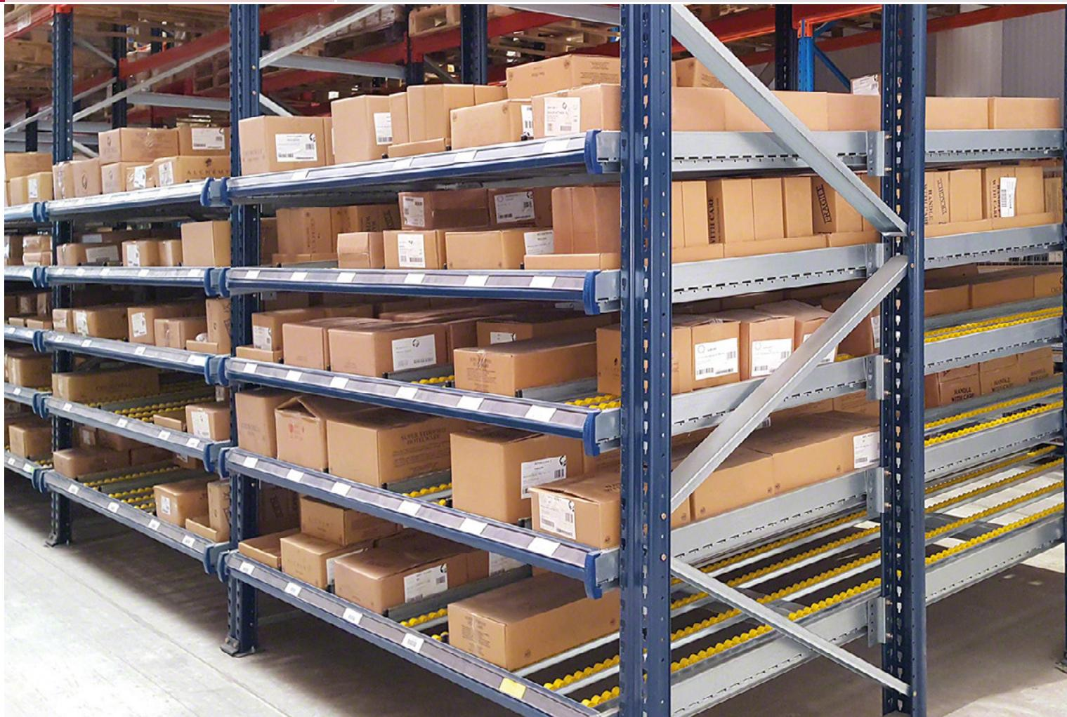
Protočni regali za kutije. Roba se postavlja na valjkaste staze pod blagim nagibom gdje se zatim pod utjecajem sile gravitacije pomiče kontroliranom brzinom prema izlaznoj jedinici.
