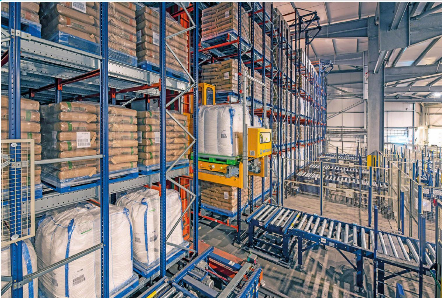
U ovom se sustavu automatska oprema uključuje u postupke upravljanja skladištima visoke gustoće. Kao rezultat toga, viličari se zamjenjuju visokoregalnim dizalicama ili kolicima za transport s Pallet Shuttleom i teretom na njihovim platformama.
