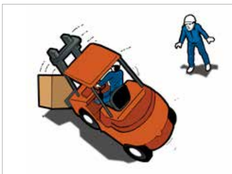
Slika 8. Gubitak kontrole nad viličarom
